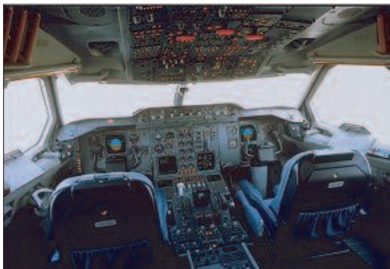
Figure 5 : Cockpit A 310 à 6 visualisations CRT 5"x5"
