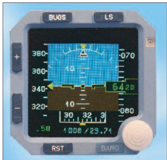
Figure 9 : Indicateur combiné de secours.
