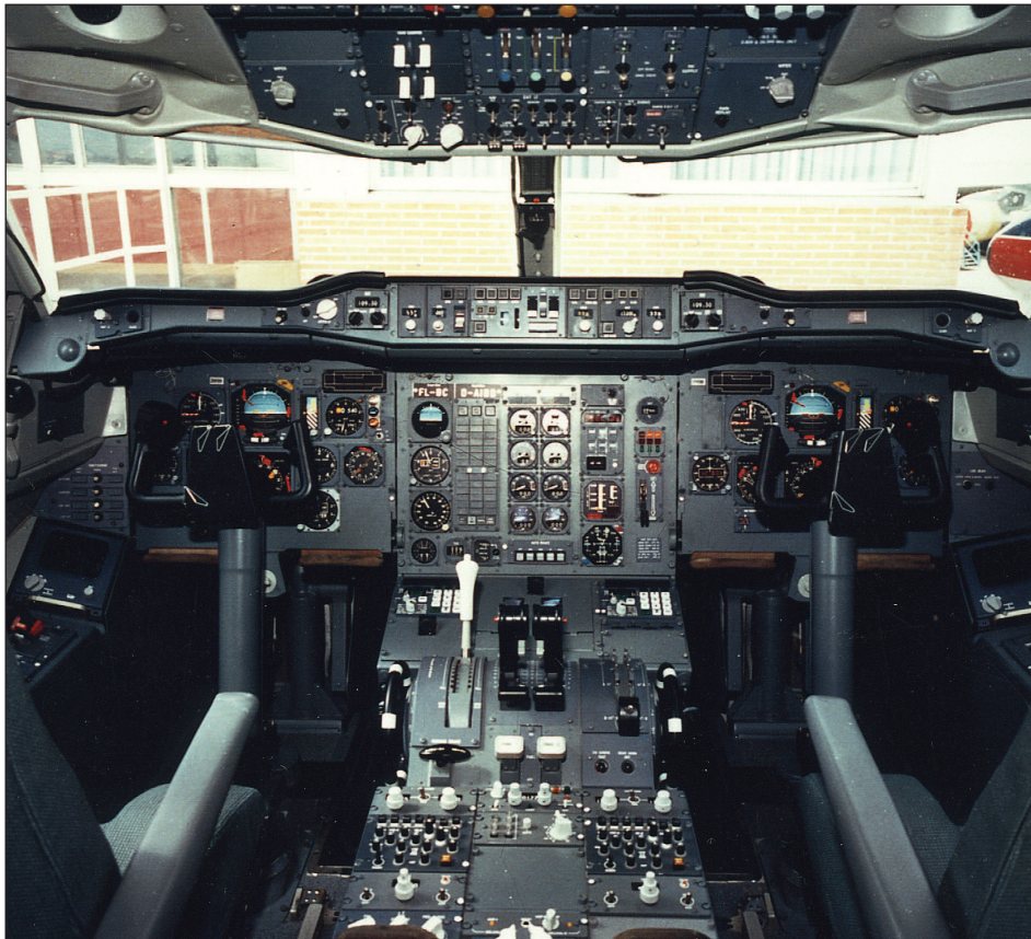
La planche de bord de l'Airbus A 300.
