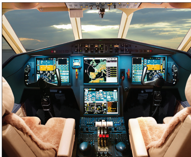
Planche de bord du Falcon 900 B Primus 2000.
