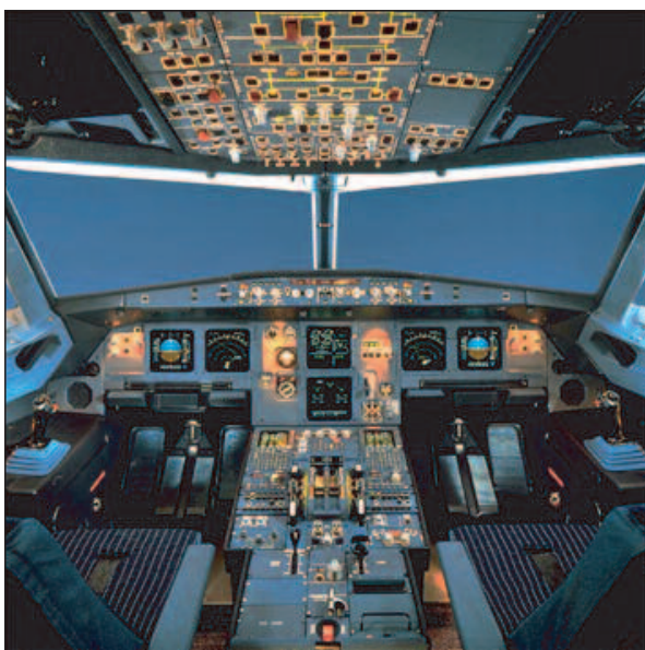
Figure 6 : Cockpit A 320 à visualisations CRT 6''x6''
