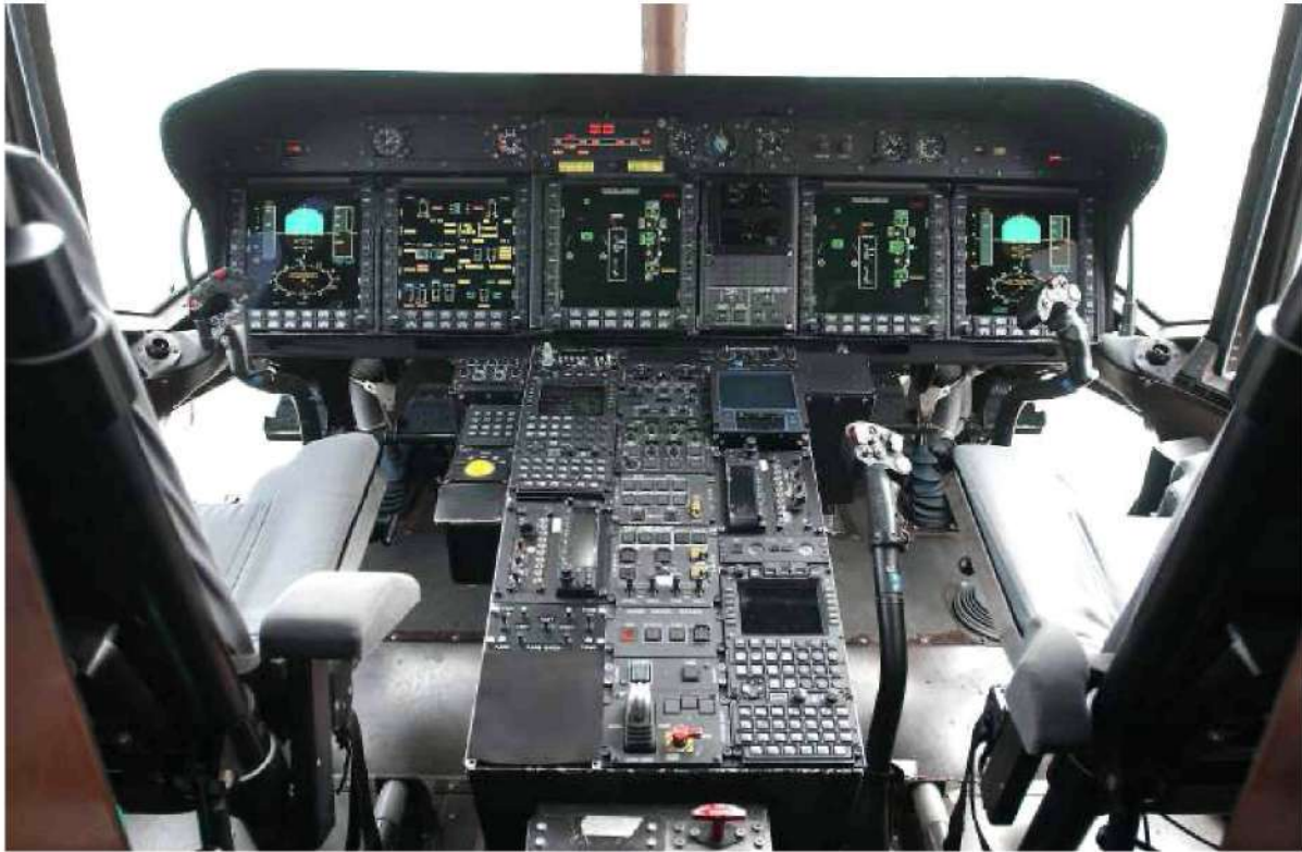
Fig. 85 Poste de pilotage du NH90
