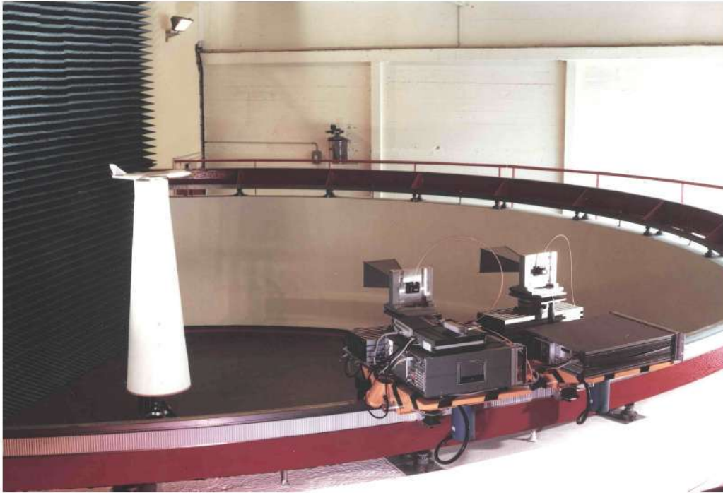
Fig. 29 Chambre anéchoïque bistatique BABI
