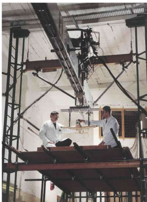
Fig. 58 Préparation d'un essai de largage d'une maquette d'avion léger à la catapulte B5 de l'IMFL, pour l'étude de la perte de contrôle
