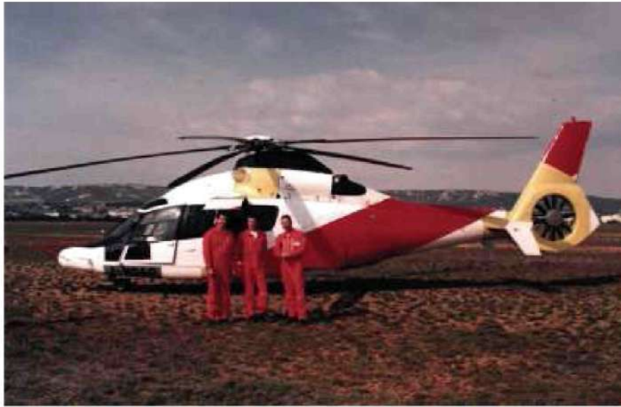
Fig. 83 Démonstrateur Eurocopter DTV4 d'hélicoptère silencieux
