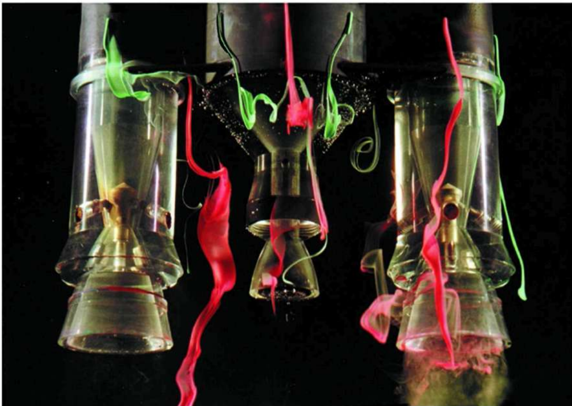
Fig. 107 Visualisation des arrière-corps d'Ariane dans le projet ATAC
