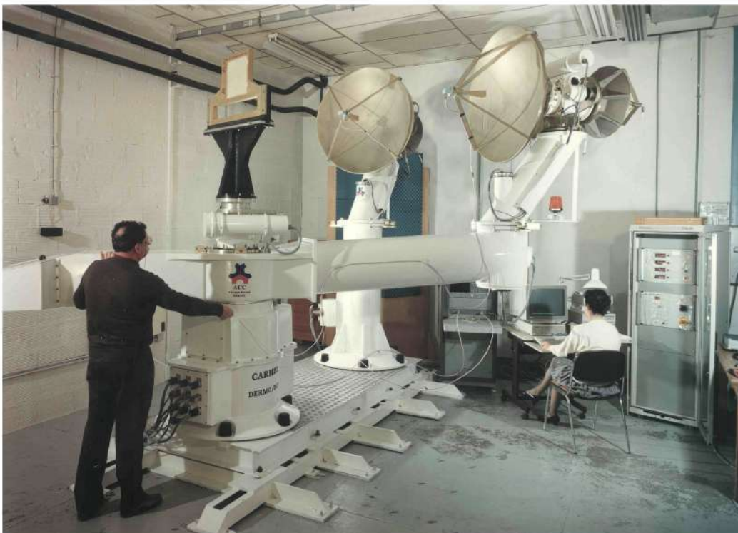
Fig. 30 Banc CARMEL pour l'analyse radar de la SER de matériaux au CERT
