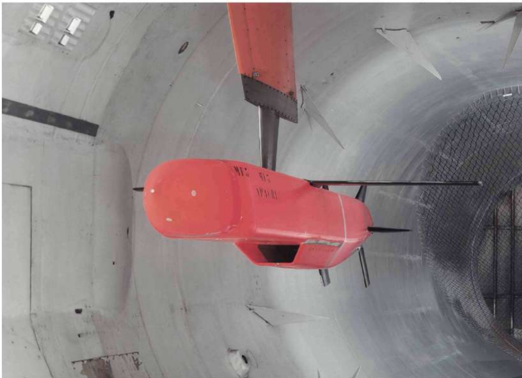
Fig. 98 Missile APACHE dans la soufflerie S1 de Modane
