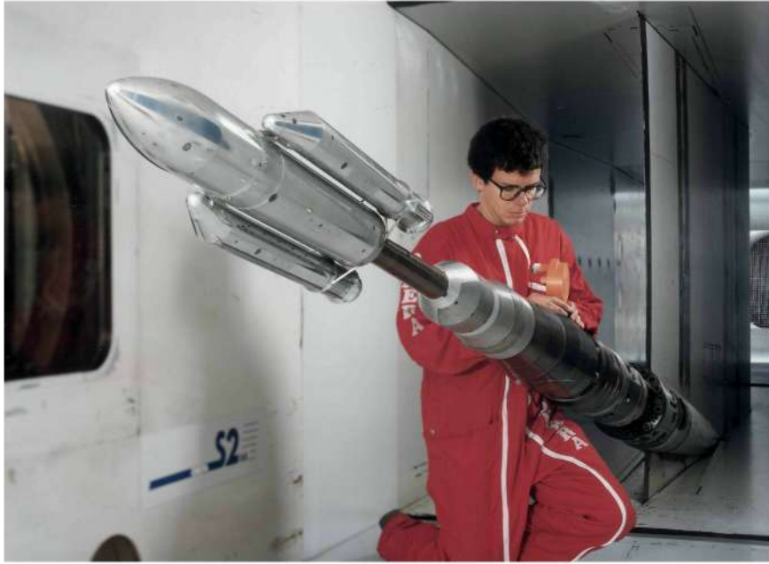
Fig. 102 Ariane dans la soufflerie S2 de Modane
