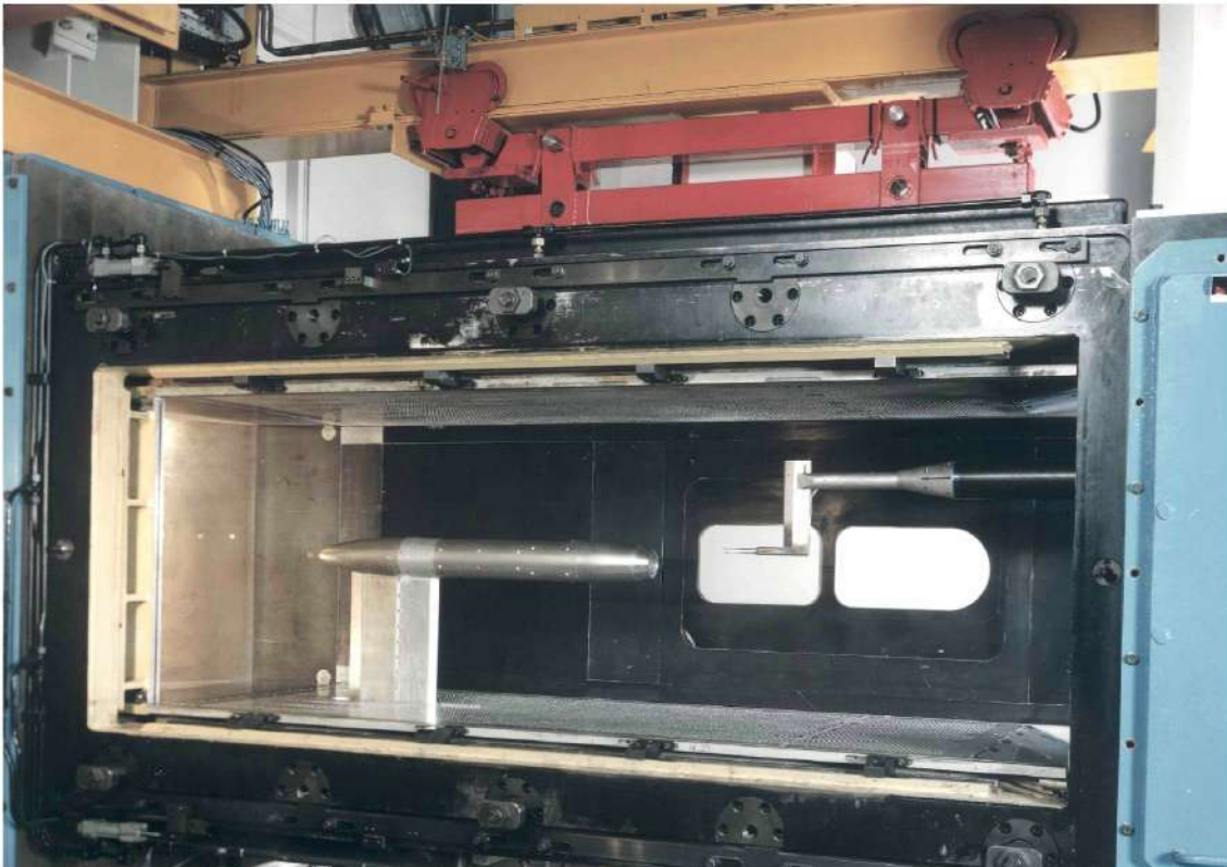
Fig. 24 Essai MARCO d'arrière-corps dans la soufflerie S3Ch de Meudon (cas monotuyère)
