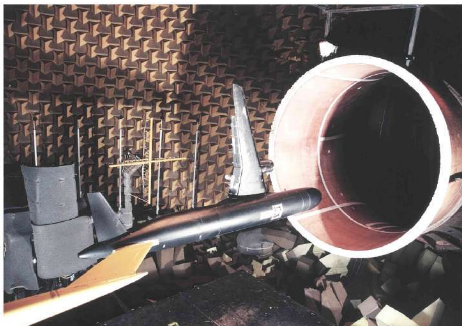
Fig. 20 Essai sur une maquette d'Airbus A321 à CEPRA 19, dans le cadre du projet européen RAIN 4.2 ( Reduction of Airframe and Installation effect of Noise )
