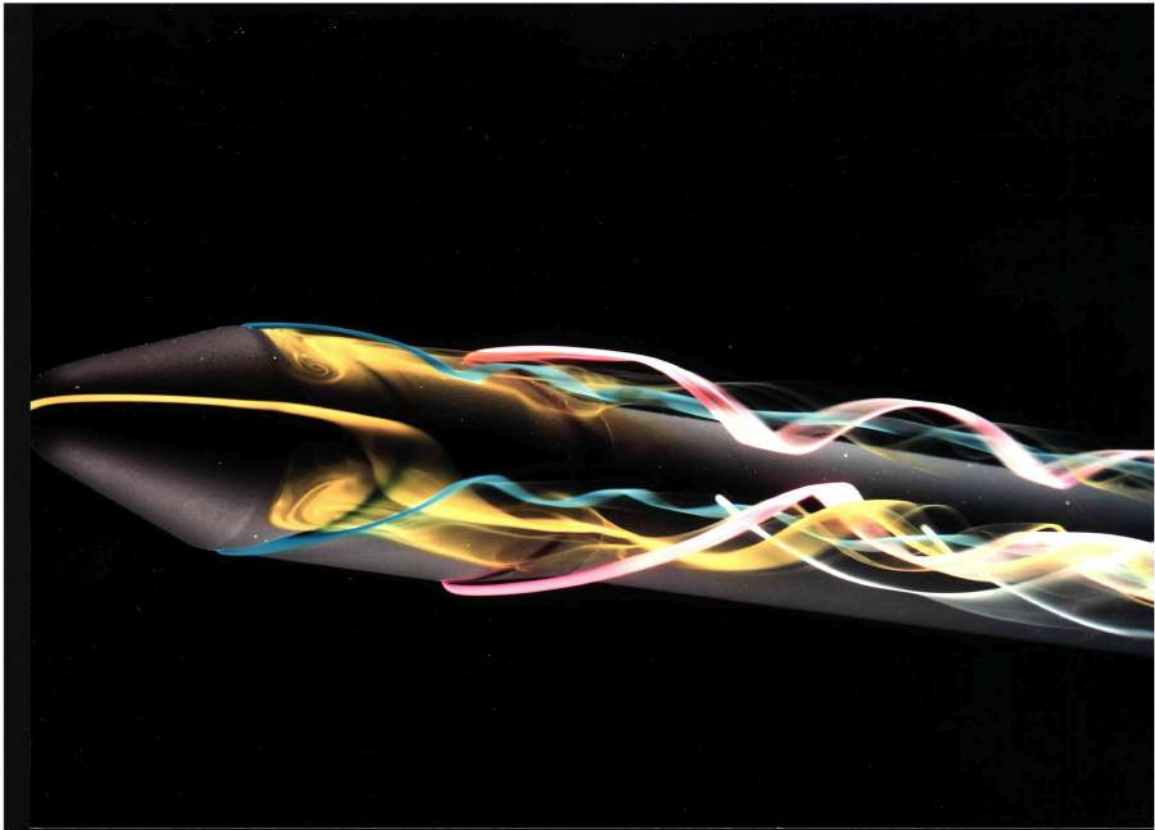
Fig. 106 Coiffe d'Ariane au tunnel hydrodynamique
