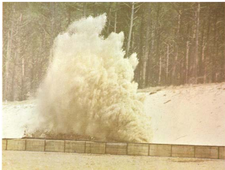
Fig. 26 Freinage mousse d'un véhicule de 100 kg à 450 m/s
