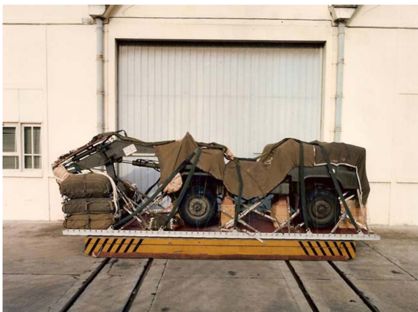
Fig. 4 Véhicule du Génie, prêt au largage
