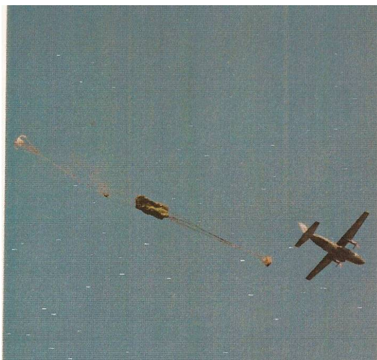
(b) Phase d'ouverture des parachutes porteurs de charge
