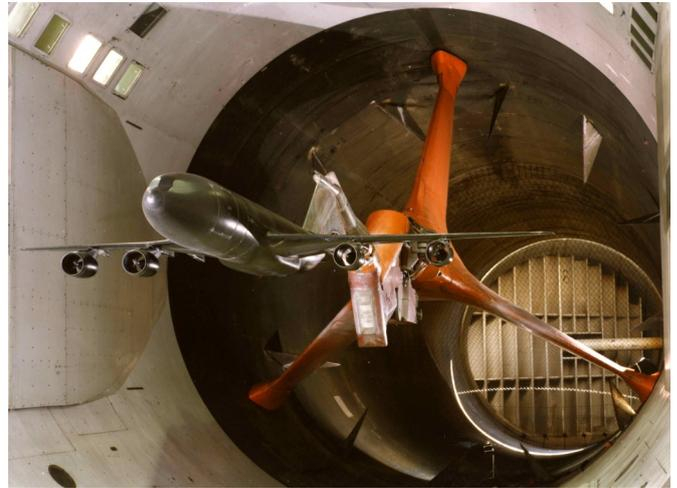
Fig. 2 - Essais de l'Airbus A380, soufflerie S1 de Modane.
