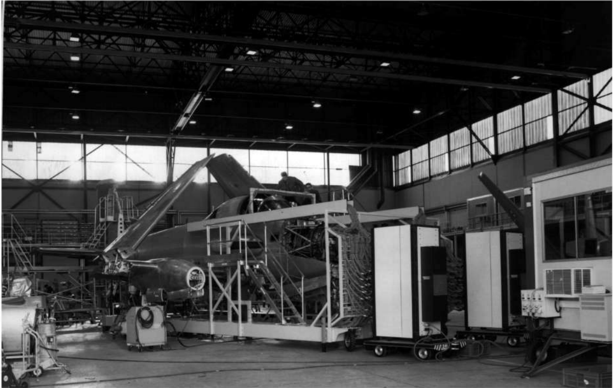
Bréguet 1050 Alizé au banc de tests automatiques des câblages
