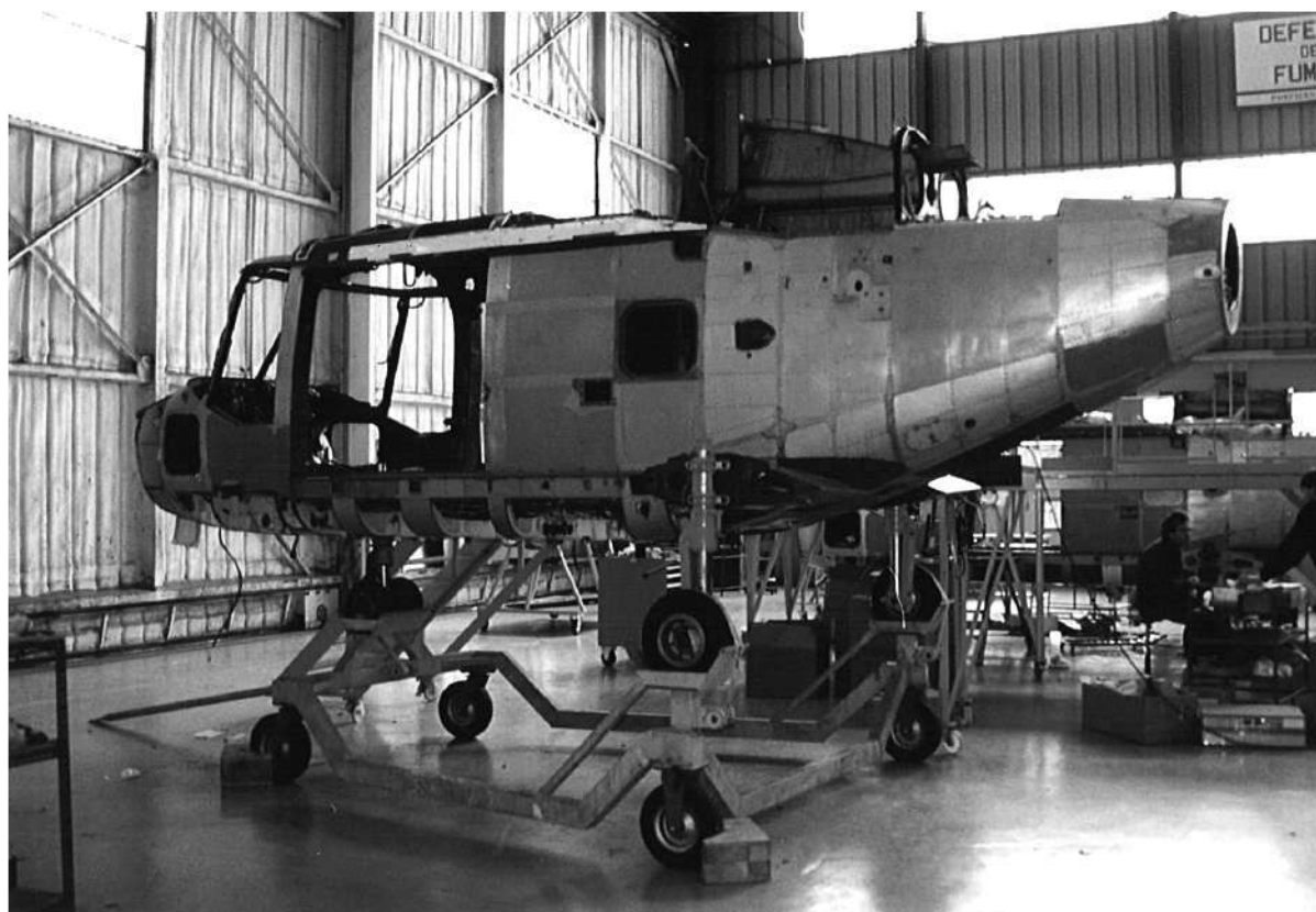
Hélicoptère Lynx sur un chariot de décapage peinture imaginé par les personnels de la chaîne en 1994
