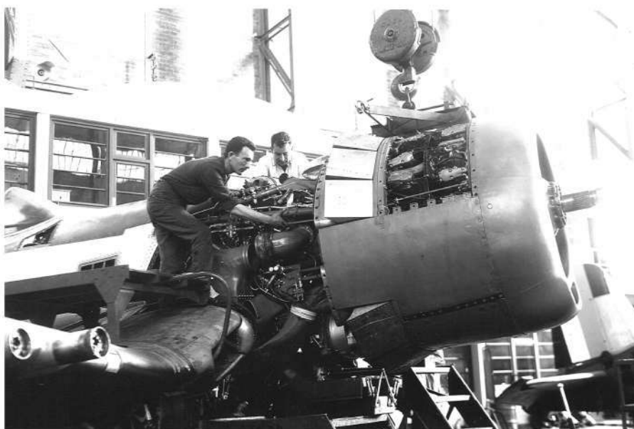
Mécaniciens reposant le moteur sur un F4U Corsair (fin des années 50)
