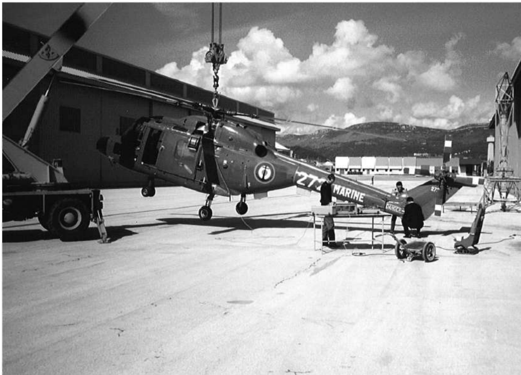
Pesée d'un Lynx permettant de déterminer sa masse et son centrage. Cette méthode est préconisée par le constructeur britannique Westland. Une pesée est nécessaire après la réalisation de travaux importants.
