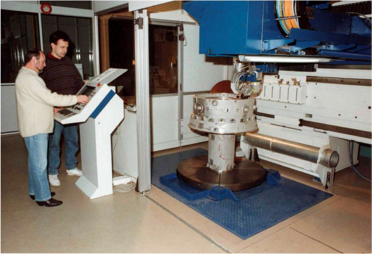
Installation de découpe laser
